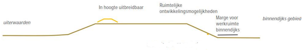
Figuur B2.6: schematische weergave principeprofiel van de 'dikke dijk'
