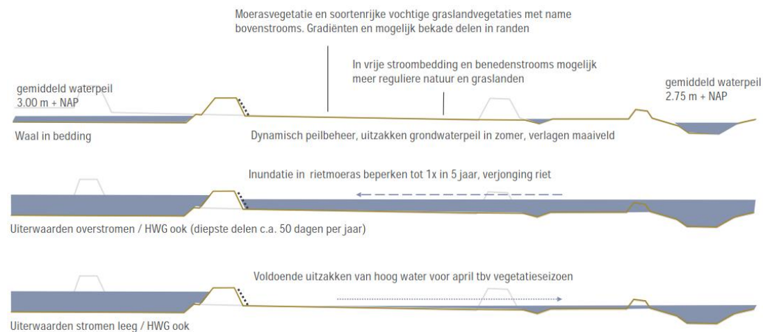
Figuur B2.17 Schematische weergave principe van regulier overstrooming (niet meestroomen) variant 2b hoogwatergeul-natuur
