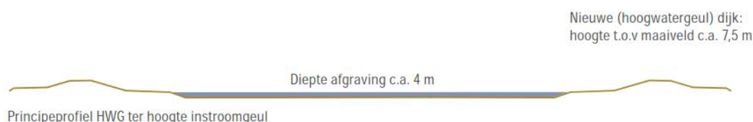
Figuur B2.11. Schematische weergave principeprofiel instroomgeul ter hoogte van de Uilenburgsestraat
