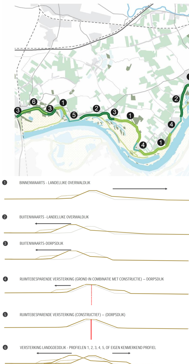
Figuur B2.5 schematische weergave locatie profielen variant 1a 'traditionele dijkversterking'
